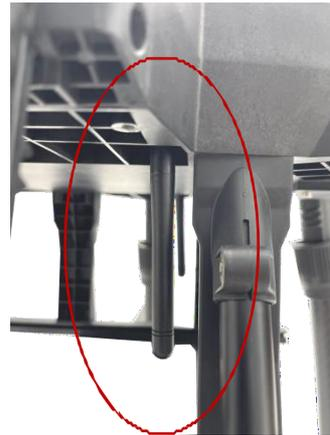
9. 수신기 설치 : 수신기 안테나 설치 완성한 모습
