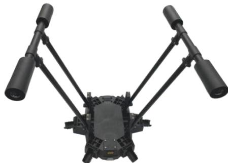
15. 스키드 설치 완료 모습
