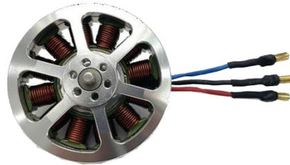
4.  $\phi 4$  바나나 잭의 수 커넥터가 사용되며 곁에 길이20mm, 직경6mm 열수축 튜브를 사용하여 절연합니다.
