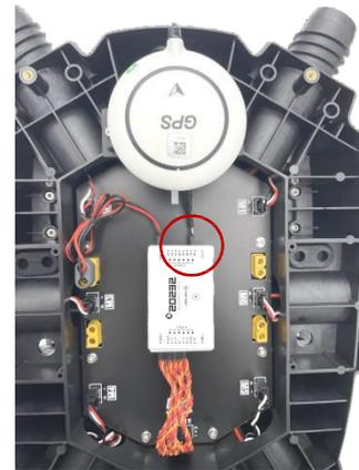
4. GPS 설치: 3M 양면 테이프를 사용하여 GPS를 GPS 스탠드에 고정하고 GPS 신호 라인을 FC에 연결합니다.
