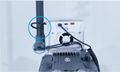
XT30电源线与Type-C数据线的连接
