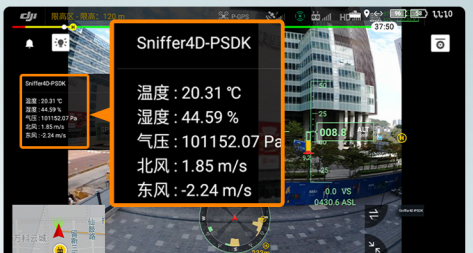
灵嗅V2气象五参检测数值在飞控软件DJI Pilot端显示
